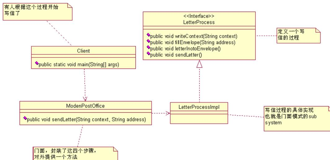
这就是门面模式，还是比较简单的，Sub System 比较复杂，为了让调用者更方便的调用，就对 Sub System 进行了封装，增加了一个门面，Client 调用时，直接调用门面的方法就可以了，不用了解具体的实现方法以及相关的业务顺序，我们来看程序的改变，LetterProcess 接口和实现类都没有改变，只是增加了一个 ModenPostOffice 类，我们这个 java 程序清单如下：
